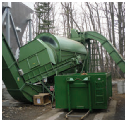
Obr. 5 – Fotografie z realizace – bubnový třídič
