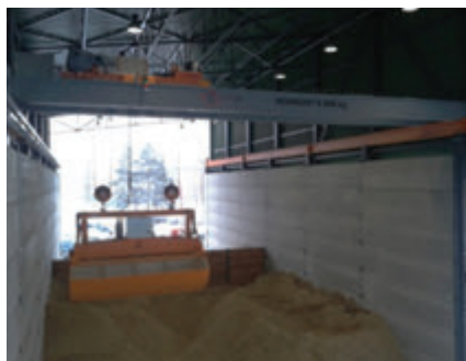
Manipulátory Simo-CZ ve skladu biomasy ve Sviadnově
